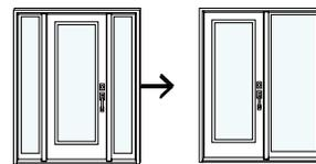
Conçu pour remplacer une configuration d'entrée avec une porte et deux latéraux de largeur 13 $\frac{3}{8}$ ".
