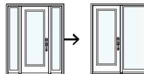
Conçu pour remplacer une configuration d'entrée avec une porte et deux latéraux de largeur 13 $\frac{7}{8}$ ".
